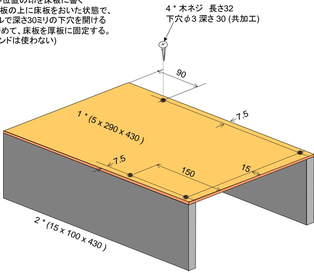
⑦ L字床を床板に乗せて、外形を鉛筆で床板に転写する。
