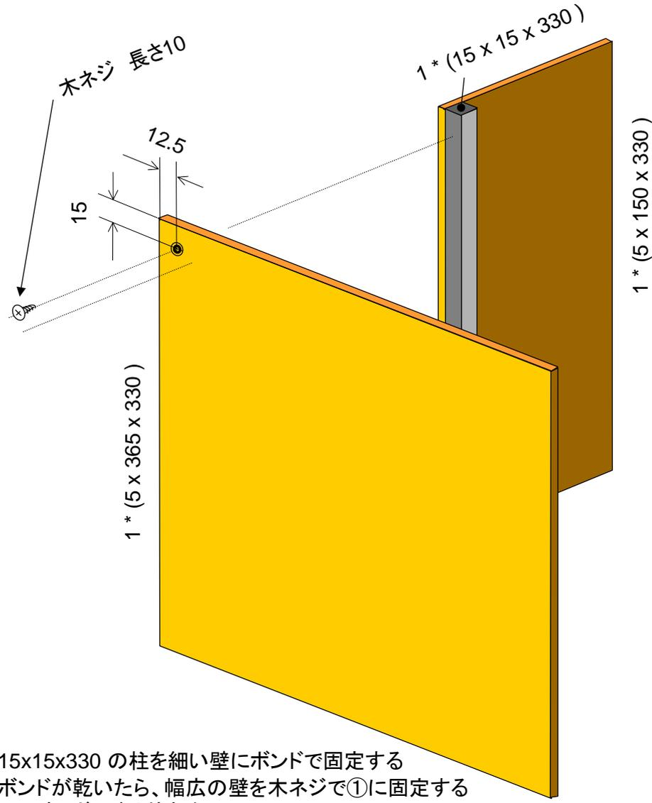
② 15x15x330 の柱を細い壁にボンドで固定する
