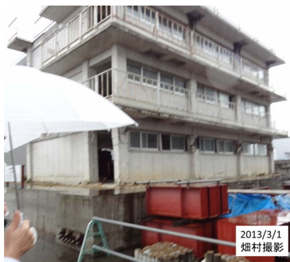
図8 実大試験で壊れたモデル校舎
