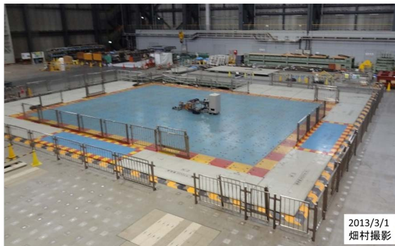
図2 震動台 (大きさ: 20m × 15m, 最大変位: 水平 ±100cm, 垂直 ±50cm, 1200トンの実大試料に水平0.9G, 垂直1.5Gの加振が可能)
