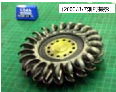
写真11 つい最近まで使われていた ペルトン水車の実物
