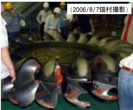
写真12 ペルトン水車の実物 (赤い部分は磨耗などせず 塗料が残っている.)
