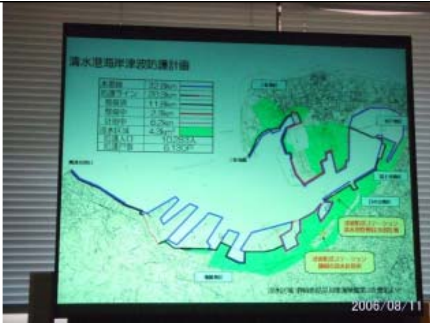
写真8 清水港の津波防護計画 約5mの高さの津波の襲来を想定している
