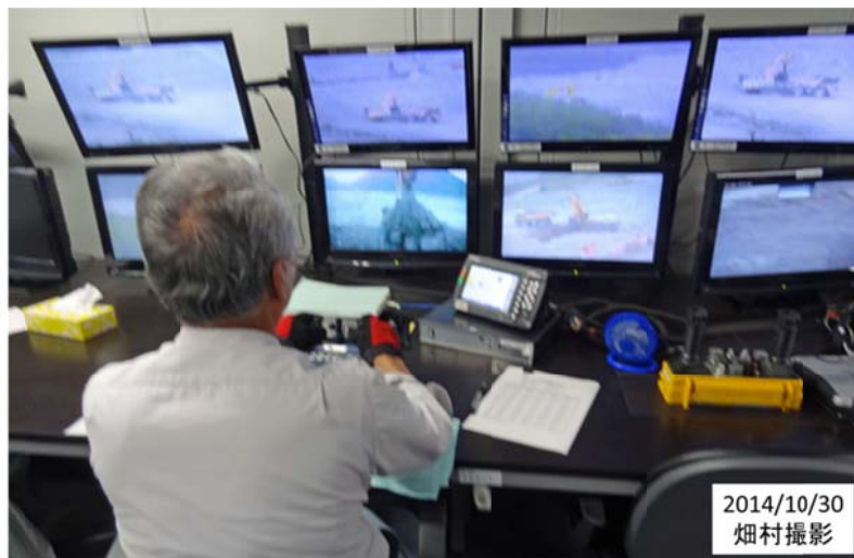
図18 無人化施工のオペレーションルーム (必要な画面が多数表示されるだけでなく、 画面の中に設計目標が表示されていた。)
