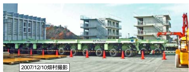
写真8 実大供試体を運ぶ多輪トレーラー
