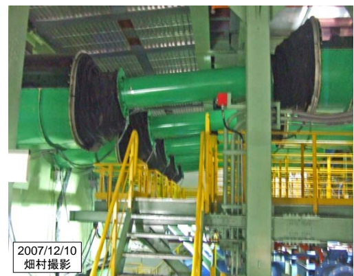
写真6 水平動油圧シリンダと震動台を繋ぐコネクティングロッド (動く震動台と固定のシリンダとの干渉防止のため)
