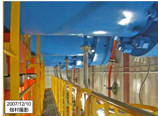
写真5 水平動油圧シリンダ(X,Y方向にそれぞれ5本, Z方向に14本) (外径1.46m, 内径0.83m, 圧力20.6Mpa, ストローク±1m)
