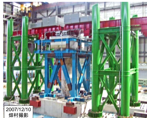
写真1 震動台上に組上げられた実大橋脚実験体
